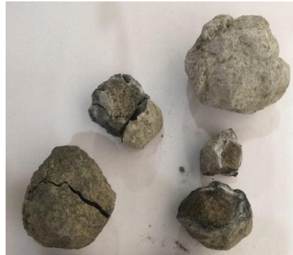
شکل ۲- کلینکر هیدراته شده دپو شرکت سیمان گیلان سبز
