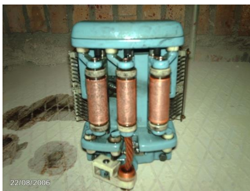
مجموعه شامل کنتاکت اصلی و کنتاکتهای فرعی
