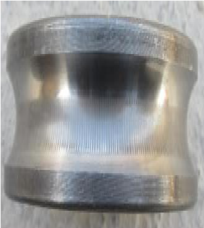
سطح رینگ داخلی یکی از بیرینگهای موتور فن گریت
