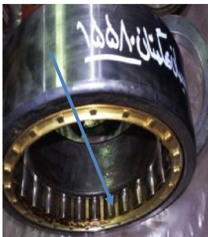
تصویر بیرینگ معیوب تعویض شده
